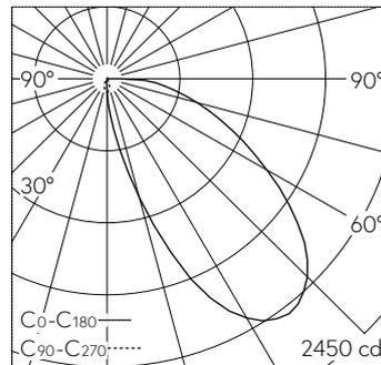
LED 4000 K 33.2 W 1531 lm-h / CIE Flux 37 73 92 100 100 / A30 nach DIN 5040
