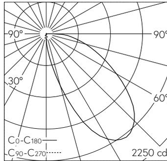
LED 2700 K 35.4 W 1403 lm-h / CIE Flux 37 73 92 100 100 / A30 nach DIN 5040
