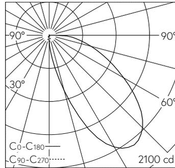
LED 2700 K 33.2 W 1332 lm-h / CIE Flux 37 73 92 100 100 / A30 nach DIN 5040
