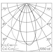
LED 4000 K 8.8 W 984 lm-h / CIE Flux 78 96 100 100 100 / A70 nach DIN 5040
