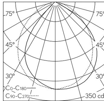
LED 4000 K 7 W 650 lm-h / CIE Flux 63 92 99 100 100 / A60 nach DIN 5040
