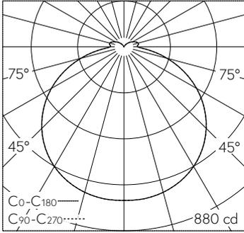
LED 4000 K 28,5 W 2745 lm-h / CIE Flux 42 73 92 90 100 / A31 nach DIN 5040
