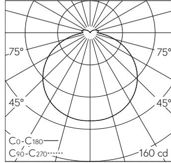
LED 4000 K 3,0 W 409 lm-h / CIE Flux 42 73 92 90 100 / A31 nach DIN 5040
