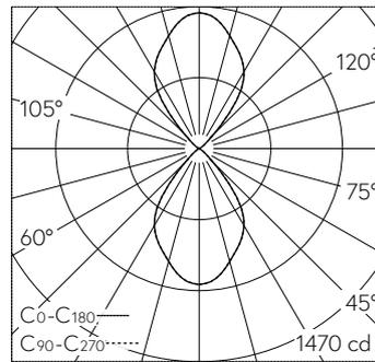
LED 4000 K 19 W 2196 lm-h / CIE Flux 88 99 100 50 100 / C84 nach DIN 5040
