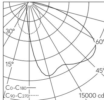
LED 3000 K 190 W 17353 lm-h / CIE Flux 46 78 96 100 100 / A40 nach DIN 5040
