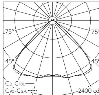
LED 4000 K 31 W 4600 lm-h / CIE Flux 69 95 99 98 100 / A62 nach DIN 5040
