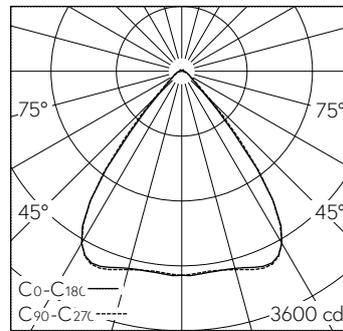
LED 4000 K 31 W 4600 lm-h / CIE Flux 85 96 99 98 100 / A71 nach DIN 5040
