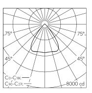
LED 4000 K 39 W 5800 lm-h / CIE Flux 85 96 99 98 100 / A71 nach DIN 5040
