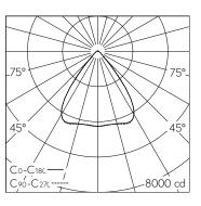
LED 4000 K 47 W 6900 lm-h / CIE Flux 85 96 99 98 100 / A71 nach DIN 5040
