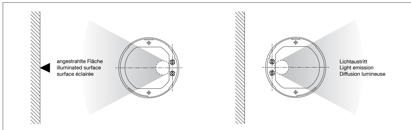
Soll der Lichtaustritt der Leuchte entgegengesetzt erfolgen, so muss die Montageplatte dazu um 180° gedreht montiert werden.
