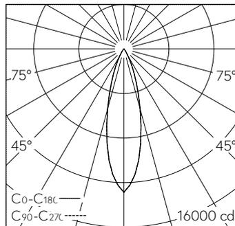
LED 4000 K 37 W 3654 lm-h / CIE Flux 99 100 100 99 100 / A81 selon DIN 5040
