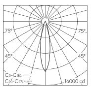
LED 3000 K 25 W 2560 lm-h / CIE Flux 99 100 100 99 100 / A81 selon DIN 5040
