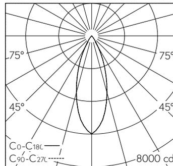
LED 4000 K 25 W 2567 lm-h / CIE Flux 98 100 100 98 100 / A81 selon DIN 5040
