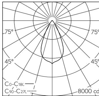
LED 4000 K 37 W 3643 lm-h / CIE Flux 88 95 98 97 100 / A81 selon DIN 5040
