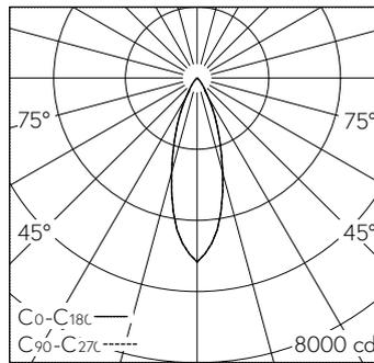
LED 36 W 2056 lm-h / CIE Flux 96 100 100 98 100 / A81 selon DIN 5040
