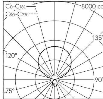
LED 4000 K 82 W 10815 lm-h / CIE Flux 66 92 98 11 100 / D63 selon DIN 5040
