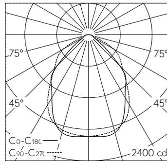
LED 3000 K 40 W 3667 lm-h / CIE Flux 65 91 98 100 100 / A60 selon DIN 5040
