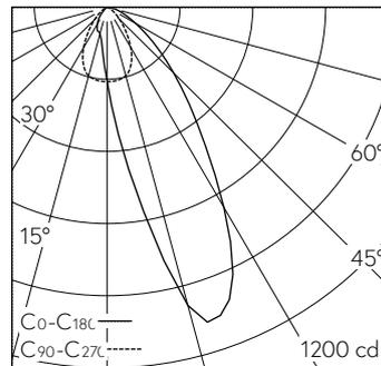
LED 2700 K 18,9 W 674 lm-h / CIE Flux 76 96 100 100 100 / A70 selon DIN 5040
