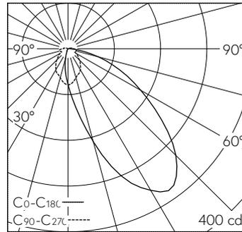
LED 2700 K 8 W 326 lm-h / CIE Flux 45 80 95 97 100 / A40 selon DIN 5040
