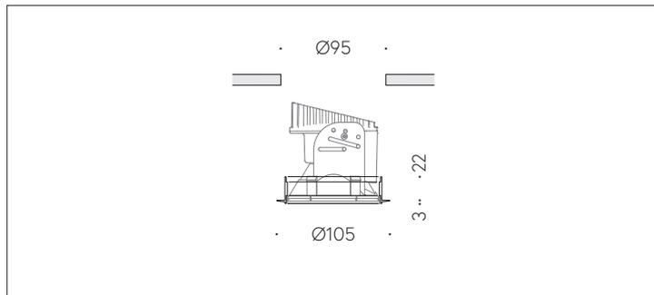
Matière synthétique blanc trafic (RAL 9016), avec anneau périphérique et rebord permettant le gypsage pour fixation dans un faux-plafond plâtre.
