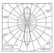
LED 2700 K 8,8 W 334 lm-h / CIE Flux 100 100 100 44 100 / C84 selon DIN 5040
