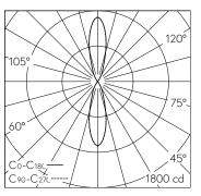
LED 3000 K 8,8 W 349 lm-h / CIE Flux 100 100 100 50 100 / C84 selon DIN 5040
