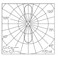
LED 3000 K 8,8 W 448 lm-h / CIE Flux 98 100 100 50 100 / C84 selon DIN 5040
