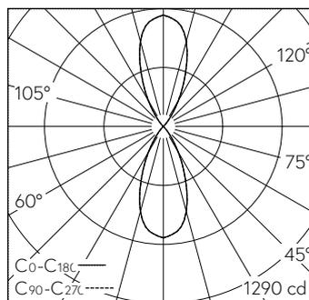
LED 4000 K 8,8 W 494 lm-h / CIE Flux 98 100 100 50 100 / C84 selon DIN 5040
