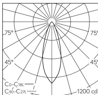
LED 3000 K 9,2 W 423 lm-h / CIE Flux 91 98 100 99 100 / A80 selon DIN 5040
