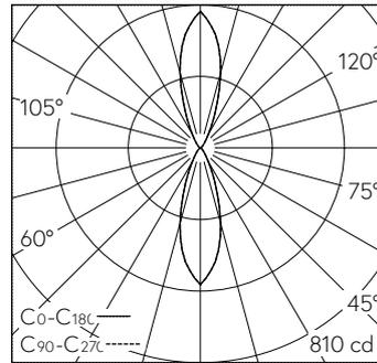
LED 3000 K 8,8 W 218 lm-h / CIE Flux 91 98 100 50 100 / C84 selon DIN 5040
