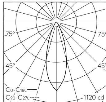
LED 2700 K 9,1 W 406 lm-h / CIE Flux 91 98 100 99 100 / A80 selon DIN 5040
