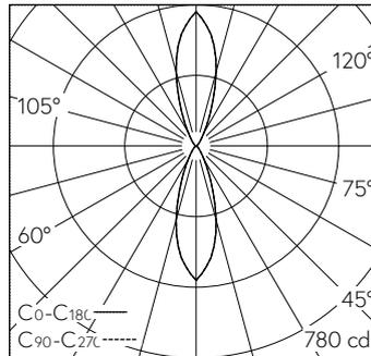
LED 2700 K 8,8 W 209 lm-h / CIE Flux 91 98 100 50 100 / C84 selon DIN 5040
