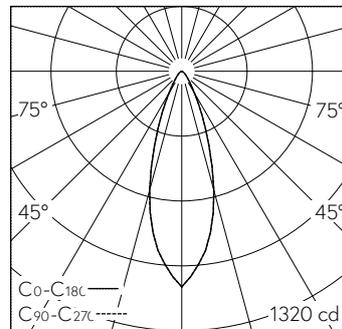
LED 4000 K 9,2 W 467 lm-h / CIE Flux 91 98 100 99 100 / A80 selon DIN 5040
