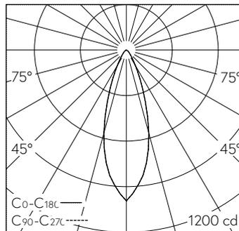
LED 3000 K 9,2 W 423 lm-h / CIE Flux 91 98 100 99 100 / A80 selon DIN 5040
