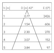
LED 3000 K 17,6 W 1266 lm-h 42° / CIE Flux 98 100 100 100 100 / A80 selon DIN 50...
