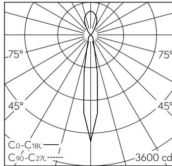
LED 4000 K 17,6 W 312 lm-h / CIE Flux 87 100 100 50 100 / C84 selon DIN 5040
