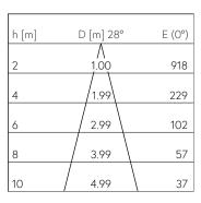
LED 2700 K 17,6 W 1397 lm-h 28° / CIE Flux 86 96 99 100 100 / A70 selon DIN 5040
