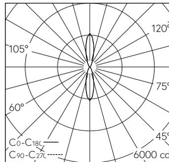
LED 4000 K 17,6 W 803 lm-h / CIE Flux 86 96 99 50 100 / C74 selon DIN 5040
