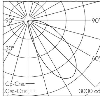
LED 2700 K 34,1 W 1722 lm-h / CIE Flux 37 73 92 100 100 / A30 selon DIN 5040
