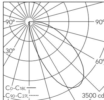
LED 3000 K 47 W 2187 lm-h / CIE Flux 37 73 92 100 100 / A30 selon DIN 5040
