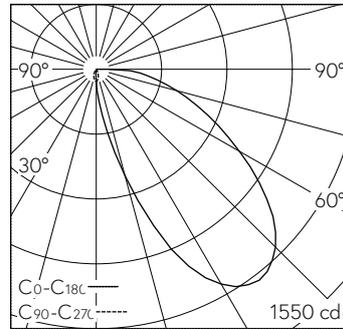
LED 2700 – 6500 K 29 W 966 lm-h / CIE Flux 37 73 92 100 100 / A30 selon DIN 5040
