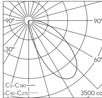
LED 3000 K 41,4 W 1966 lm-h / CIE Flux 37 73 92 100 100 / A30 selon DIN 5040
