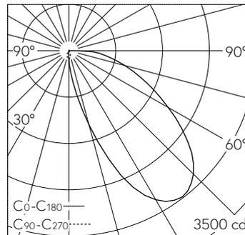
LED 4000 K 41.4 W 2116 lm-h / CIE Flux 37 73 92 100 100 / A30 selon DIN 5040
