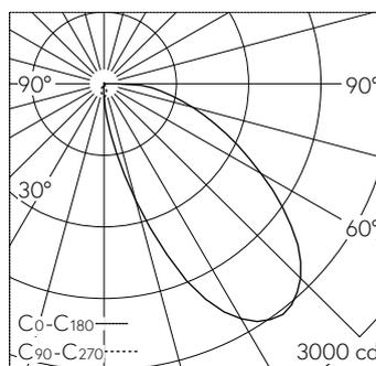
LED 4000 K 35,1 W 1853 lm-h / CIE Flux 37 73 92 100 100 / A30 selon DIN 5040
