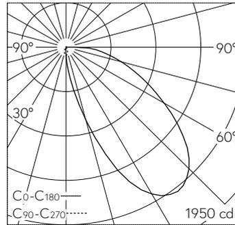
LED 2700 K 25.5 W 1213 lm-h / CIE Flux 37 73 92 100 100 / A30 selon DIN 5040
