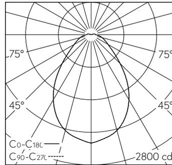
LED 4000 K 57 W 6076 lm-h / CIE Flux 59 83 94 96 100 / A50 selon DIN 5040
