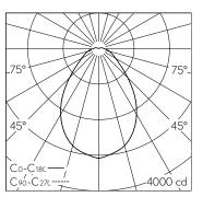
LED 3000 K 61 W 6383 lm-h / CIE Flux 59 83 94 96 100 / A50 selon DIN 5040
