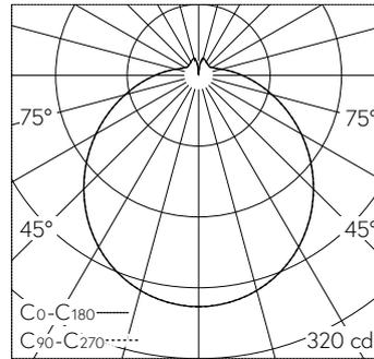
LED 3000 K 15.5 W 1024 lm-h / CIE Flux 41 69 88 86 100 / B31 selon DIN 5040
