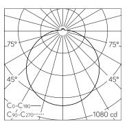
LED 3000 K 29.4 W 3088 lm-h / CIE Flux 43 73 91 93 100 / A31 selon DIN 5040
