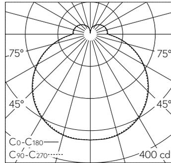
LED 3000 K 13.2 W 1324 lm-h / CIE Flux 39 68 88 80 100 / B31 selon DIN 5040
