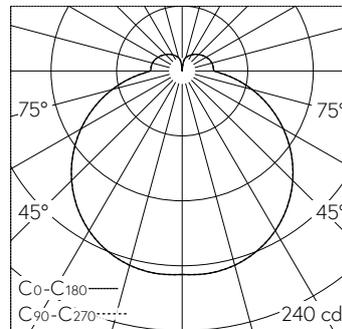
LED 2700 K 8.4 W 827 lm-h / CIE Flux 40 70 89 82 100 / B31 selon DIN 5040
